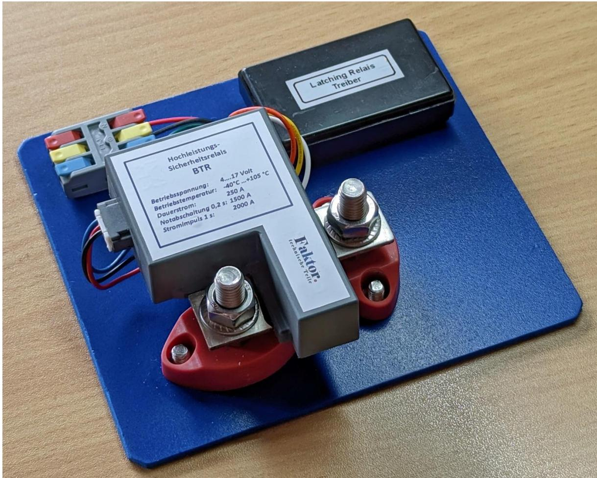
Wenn Sie die Hochstromleitungen an den Relais Schaltkontakten befestigen wollen, dann entfernen Sie zunächst das Relais von den Pfosten. Jetzt bringen Sie die Hochstromleitungen mit „umgedrehter“ Kabelschelle an, bevor Sie abschließend das Relais mit den **Laschen direkt auf den Kabelschellen befestigen:**
