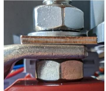
**Achten Sie darauf, dass sich zwischen Kabelschellen und Relaislaschen keine Unterlegscheiben oder Federringe befinden!!**
