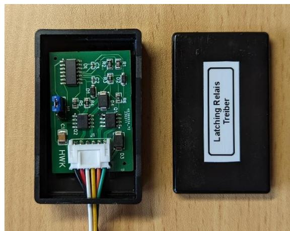
Wird der Eingang von der Versorgungsmasse getrennt, wird entsprechend der Reset-Transistor für eine Dauer von 100 ms aktiviert und der Reset-Impuls für das Relais ausgelöst.
