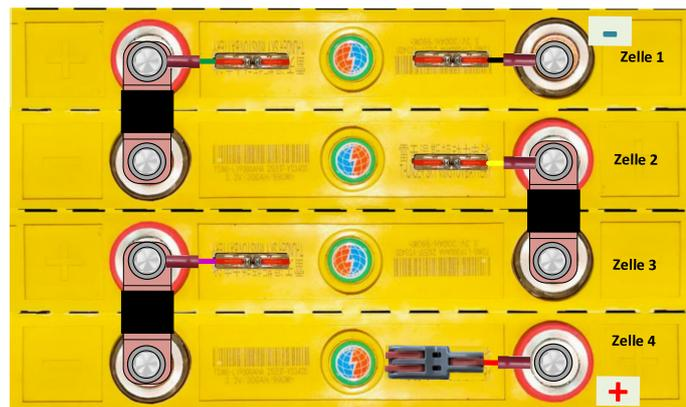
Bei der Verschraubung der Ringkabelschuhe an den Polen der Zellen muss unbedingt die Reihenfolge der Scheiben und Federringe eingehalten werden, wie weiter unten dargestellt.
