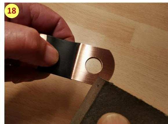
Nachdem wir alle 8 Pole präpariert haben, werden noch die 3 Verbindungsstege auf der Oberseite und der Unterseite gesäubert.
