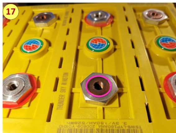
Es genügt eine dünne Schicht auf den runden Inserts der Pole, die später die eigentliche Kontaktfläche bilden. Den Rest kann man mit einem Tempotaschentuch entfernen.
