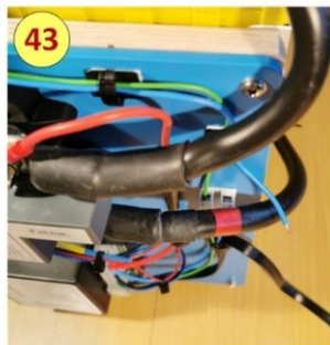
Was noch fehlt ist der Anschluss der grünen und der blauen Leitungen, die lose herunabhängen.
