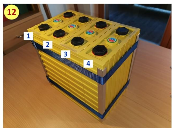
Wir haben jetzt einen kompakten Batterieblock, der ohne Gehäuse in sich stabil ist.
