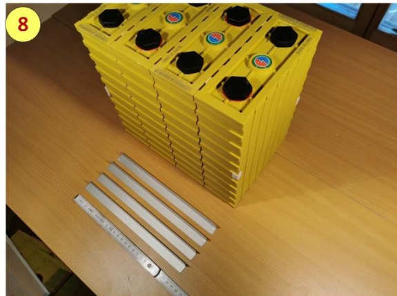
Nach dem Anpressen von Zelle 1 besorgen wir uns 1 m Alu Winkelprofil 15 mm x 15 mm. Wir teilen das Winkelprofil in 4 gleiche Teile.
