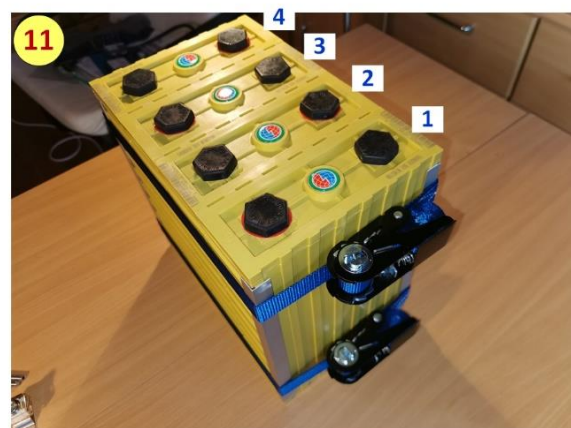
Zum Abschluss werden die Zellen mit 2 Spanngurten mit Ratsche zusammengepresst
