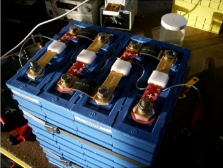
Überprüfen Sie den Widerstand der Signalleitung. Wenn alle Zellen in Ordnung sind, sollten etwa 0,75 Ohm pro Zelle aufgezeichnet werden. Ein sehr hoher Widerstand oder offener Stromkreis zeigt ein Problem entweder mit einer Zelle oder mit einem Zellenmodul an.
