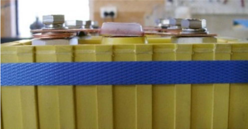
Wo Klemmen angeschlossen werden sollen, sollte ein Anschlussstift aus einer 40mm langen Gewindestange hergestellt werden. Edelstahl wird gezeigt, aber Messing wird empfohlen.
