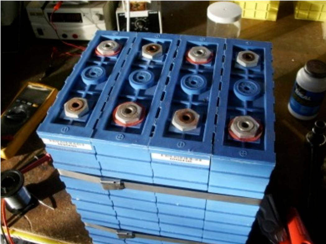
Reinigen Sie die Anschlüsse gründlich, um die Oxidschicht zu entfernen, und lassen Sie blankes Metall zurück. Am besten ist es, mit einer sauberen Metallfeile oder einer Edelstahldrahtbürste zu feilen.
