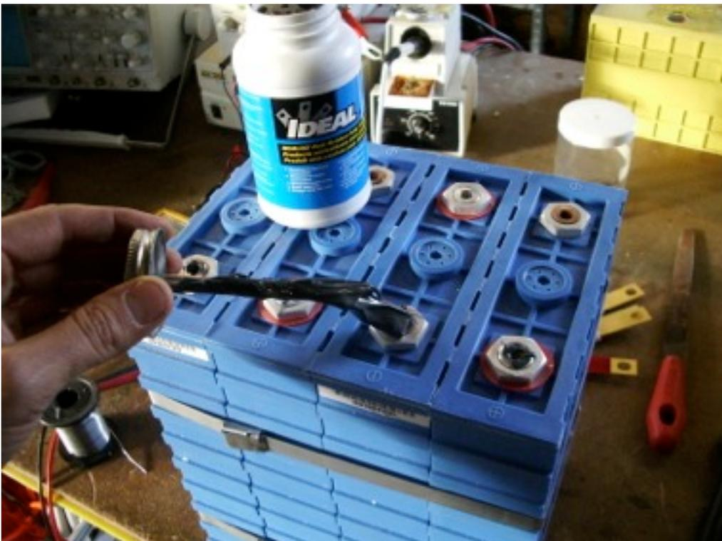
Beginnen Sie mit dem Verlegen der Zellenmodule auf den Verbindungselementen der Zellen. Die Schrauben sollten so lange fest angezogen werden, bis eine Reihe fertig ist. Lassen Sie den Link am Ende jeder Zeile bis zum Ende aus. Wenn ein
