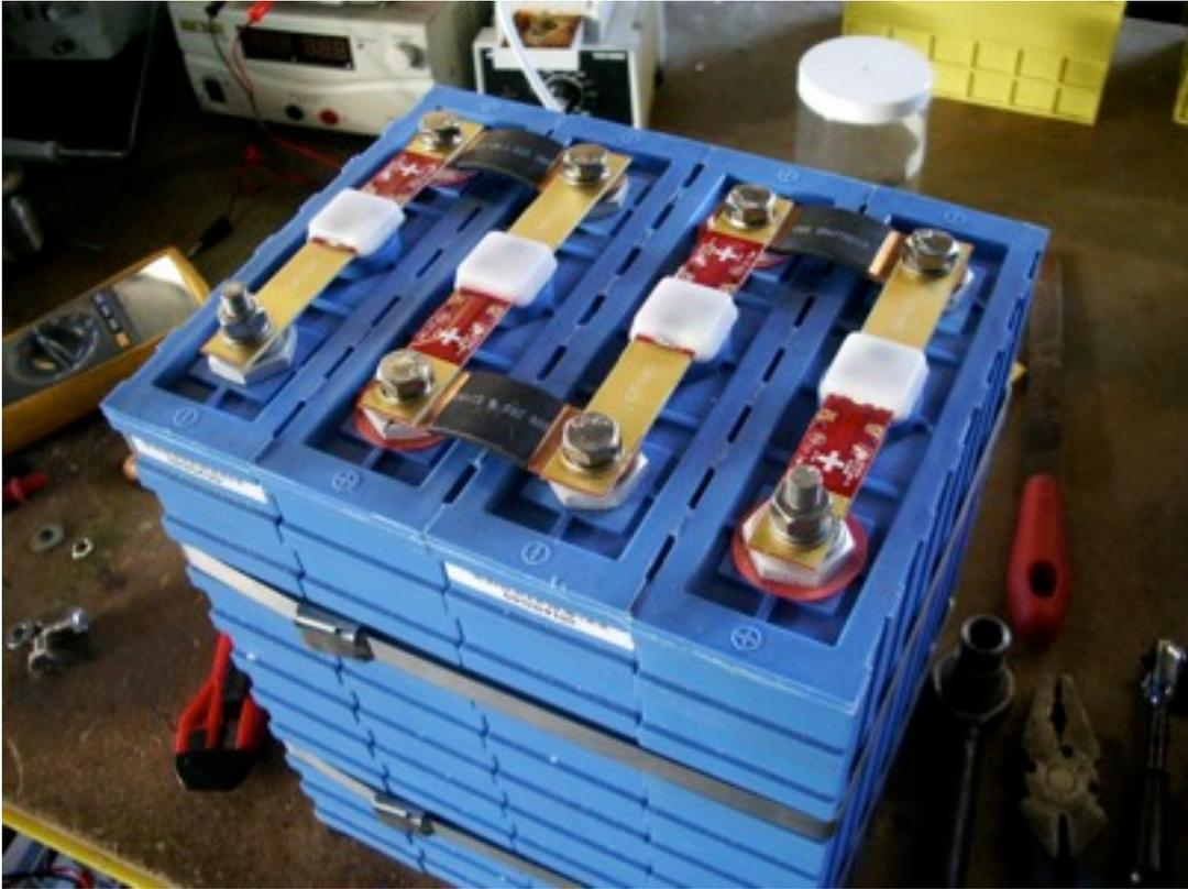
Ziehen Sie die Schrauben mit einem Schraubenschlüssel fest. Beachten Sie die Isolierung am Griff, dies kann versehentliche Kurzschlüsse verhindern, die sehr gefährlich sein können. Lassen Sie die Verbindung, die die Enden von zwei Reihen verbindet, aus, bis alles andere abgeschlossen ist. Drehmomenteinstellungen gemäß Herstellerangaben. 30 ft lbs ist angemessen. In der Regel sollte die Schraube fest genug sein, damit die Federscheibe flacht.
