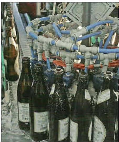
**Eisenbichler:** Die Flaschen werden mittels Erkennungssoftware mit bereits eingespeisten Flaschen verglichen und zugeordnet. Die Wegstrecke zum eigentlichen Sortierstern ist definiert. Somit kann der erkannten Flasche (Erkennungszeit: 16 ms) eine Tasche im Sortierstern zugeordnet werden.
