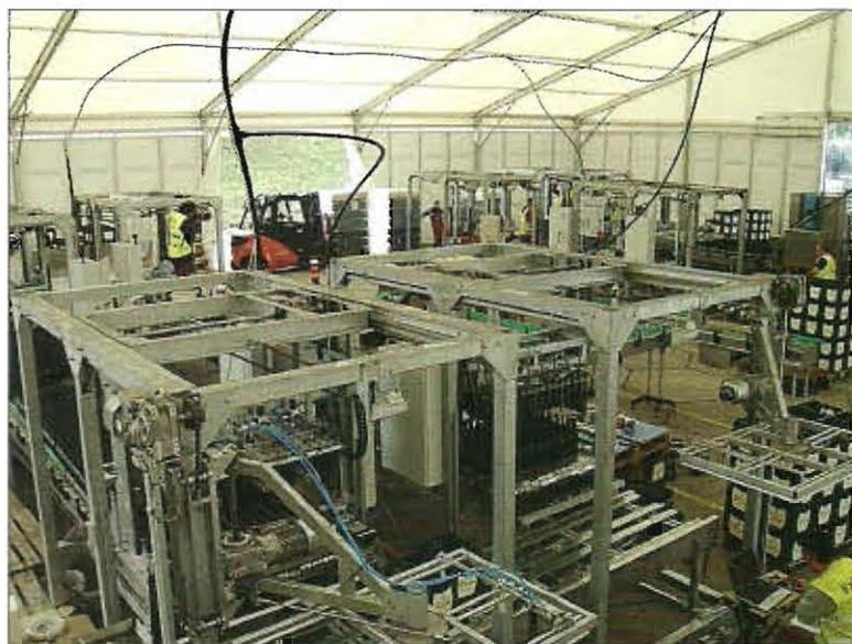
Die Kästen kommen unsortiert aus dem Handel und werden am Entpalettierer, welcher direkt am Flaschenauspacker positioniert ist, auf ein Förderband gestellt. Die Flaschen werden dann aus den Kästen gepackt, die leeren Kästen anschließend zum parallel zum Auspacker stehenden Einpacker transportiert. Aus- und Einpacker sind auf ca. 40 000 Flaschen/Stunde ausgelegt.
