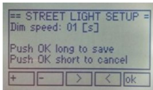
Abbildung 20: Beleuchtungsmodul Setup – Dimmgeschwindigkeit
