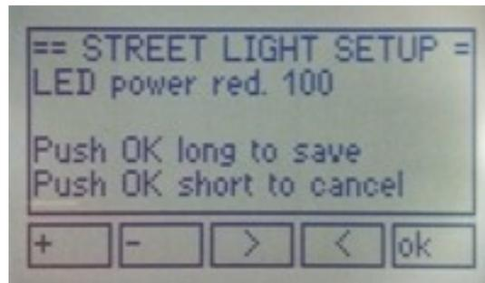
*Abbildung 16: Beleuchtungsmodul Setup – LED Helligkeit reduziert*
