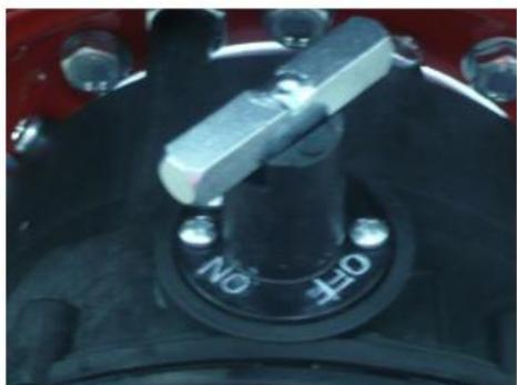
Abbildung 1 – Motorbremse eingeschaltet
