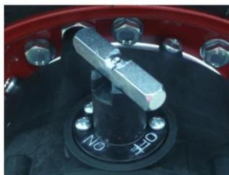
Abbildung 2 – Motorbremse ausgeschaltet
